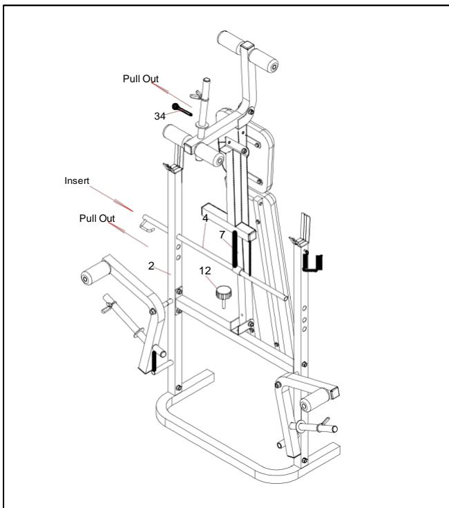
6. При складывании: удалите фиксатор (12), верхнюю опору спинки (4), поднимите соединительную раму (7), после вставьте верхнюю опору спинки (4) в 1 стойку под штангу (2) и круглую трубку внизу соединительной рамы (7), затем в другую стойку(2).
