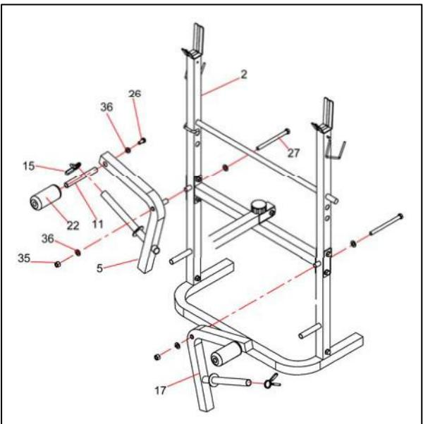
3. Зафиксируйте основы перил(правая)(5)&(левая)(17) на 2 стойках под штангу (2) болтом (27), шайбой (36) и гайкой (35), затем закрепите ось для валиков (11) опоры перил(правая) (5) & (левая) (17) с помощью болта(26) и плоской шайбы (36), установите валики из пенорезины(22) и пружинные защелки (15), как показано на рисунке.
