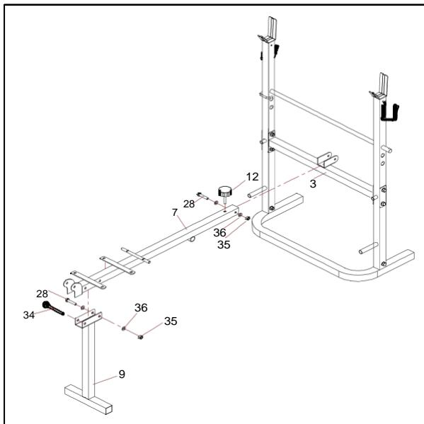
2. Прикрепите один конец соединительной рамы (7) к связывающей перекладине (3) с помощью болта (28), шайбы (36) и гайки (35), затем установите фиксатор (12).
