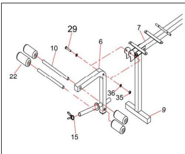
4. Прикрепите основание опоры для ног (6) у держателям на соединительной раме (7) с помощью болта (29), шайбы (36) и гайки (35). Вставьте опору для ног (10) в отверстие на основании (6), установите 4 валика из пенорезины (22) по обе стороны, затем закрепите пружинными защелками (15), как показано на рисунке.
