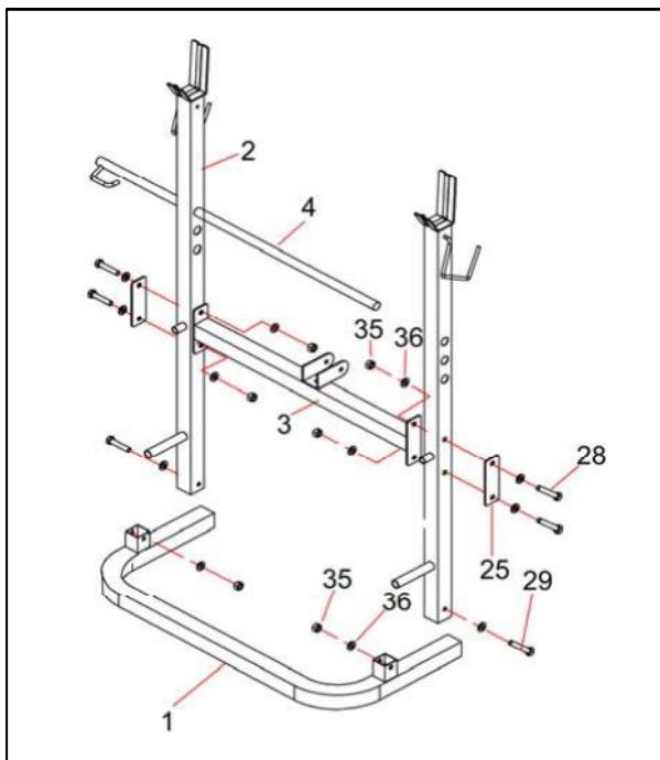
1: Зафиксируйте 2 стойки под штангу (2) с обеих сторон U-образным основанием (1) с помощью болта (29), плоской шайбы (36) и гайки(35); затем закрепите связывающую перекладину (3) к 2 вертикальным стойкам (2) с помощью болта (28), 2 стальных пластин (25), плоской шайбы (36) и гайки (35).
