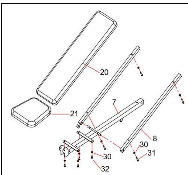
5. Зафиксируйте 2 держателя спинки (8) на оси соединительной рамы (7), затем прикрепите спинку (20) к двум держателям (8) с помощью болта (31) и шайбы (30). Зафиксируйте сиденье (21) на соединительной раме (7) болтом (32) и шайбой (30), как показано на рисунке.
